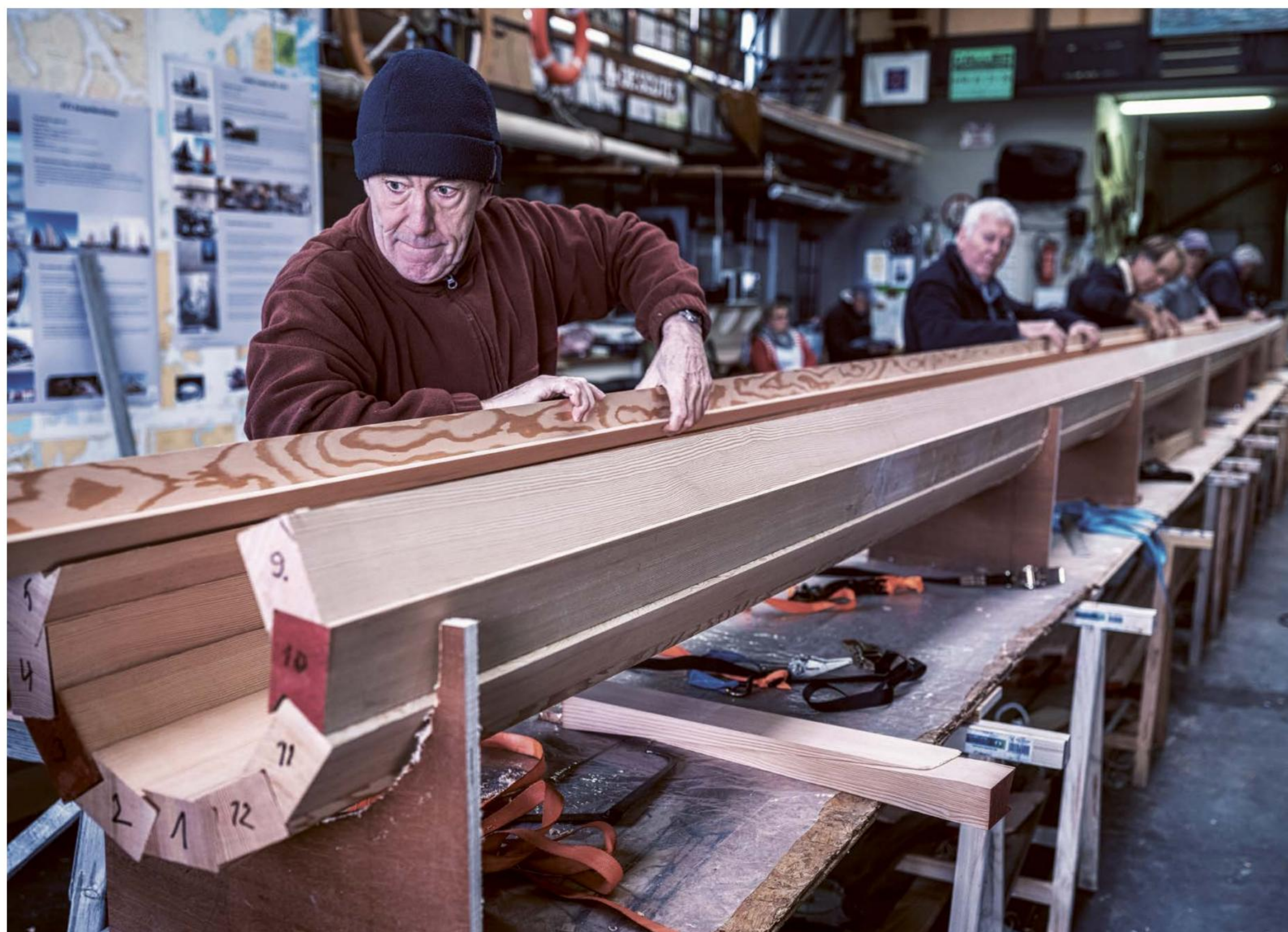
De Scute vzw bouwt een nieuwe mast voor de Blankenbergse schuit B1 Sint-Pieter. Deze vereniging zet zich in om verloren gegane sloopstypes van de Vlaamse vissersgemeenschappen te herbouwen, te restaureren en opnieuw te laten varen. © Luc Daelemans
